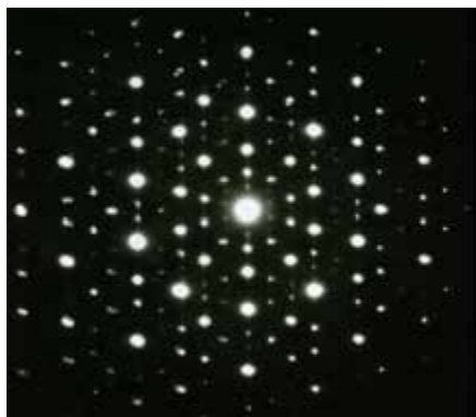
12. ábra. Különböző röntgendiffrakciós képek, balra egy kvázikristályé (ez a tízfogású forgási szimmetriából megállapítható), jobbra egy amorf anyagé
