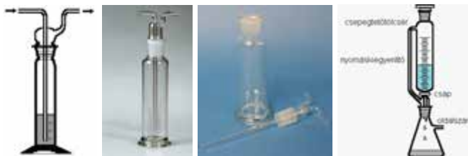
Gázmosópalack (bal oldali 3 kép) és nyomáskiegyenlítővel rendelkező csepegtetőtölcsér (jobbra)
