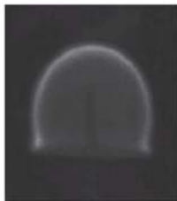
Flamme im schwerelosen Raum (ohne Konvektionsströmung)
